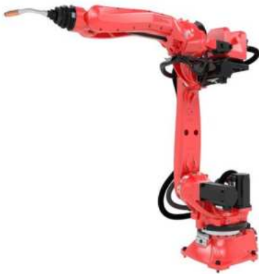
Die Roboter der S-Familie wurden nach Fraunhofer-Verfahren auf Energieeffizienz geprüft und zertifiziert und sind mit einer Reichweite von 1700 Millimetern und einer Wiederholbarkeit von plus/minus 0,03 Millimetern erhältlich. (Bild: Comau)
