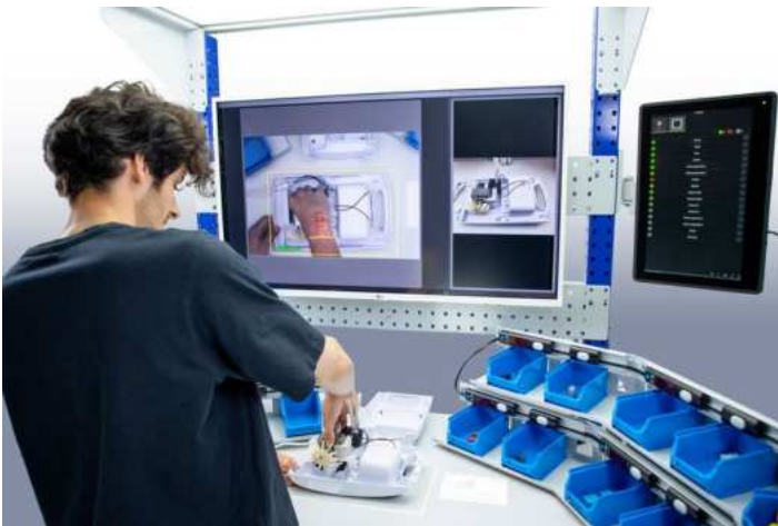
„Der Schlaue Klaus“ erkennt den Arbeitsfortschritt und reagiert situationsabhängig. Der Worker bekommt am Bildschirm die Schritt-für-Schritt-Anleitung. (Bild: Krieg)
